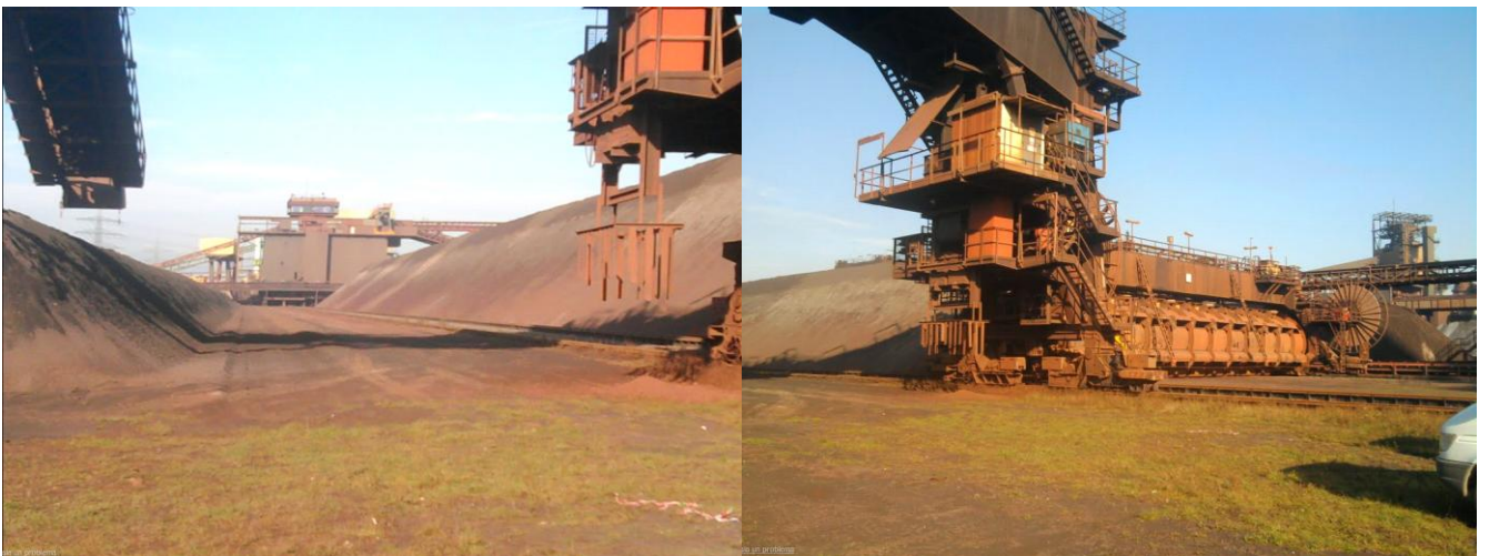
Fig. 5 – Sistemi di scarico dei minerali per la formazione dei cumuli e per il recupero
