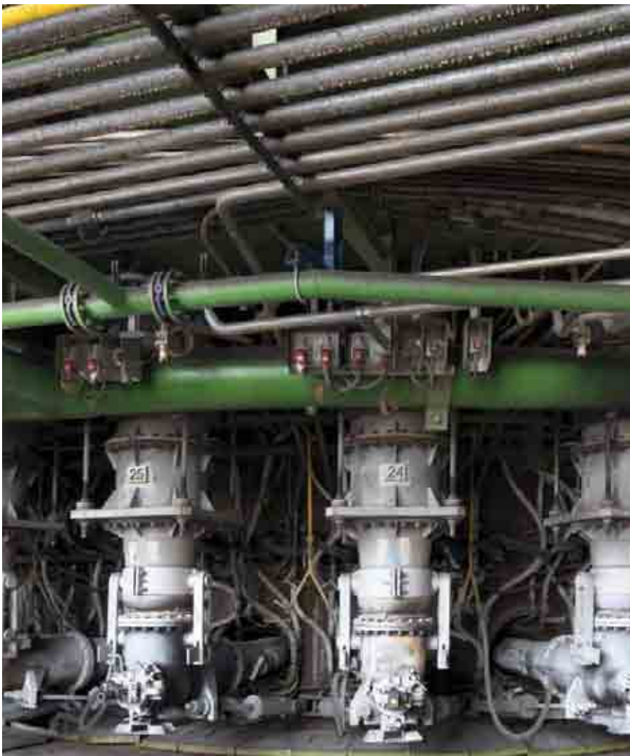
Figura 134 Piano tubiere di un altoforno
