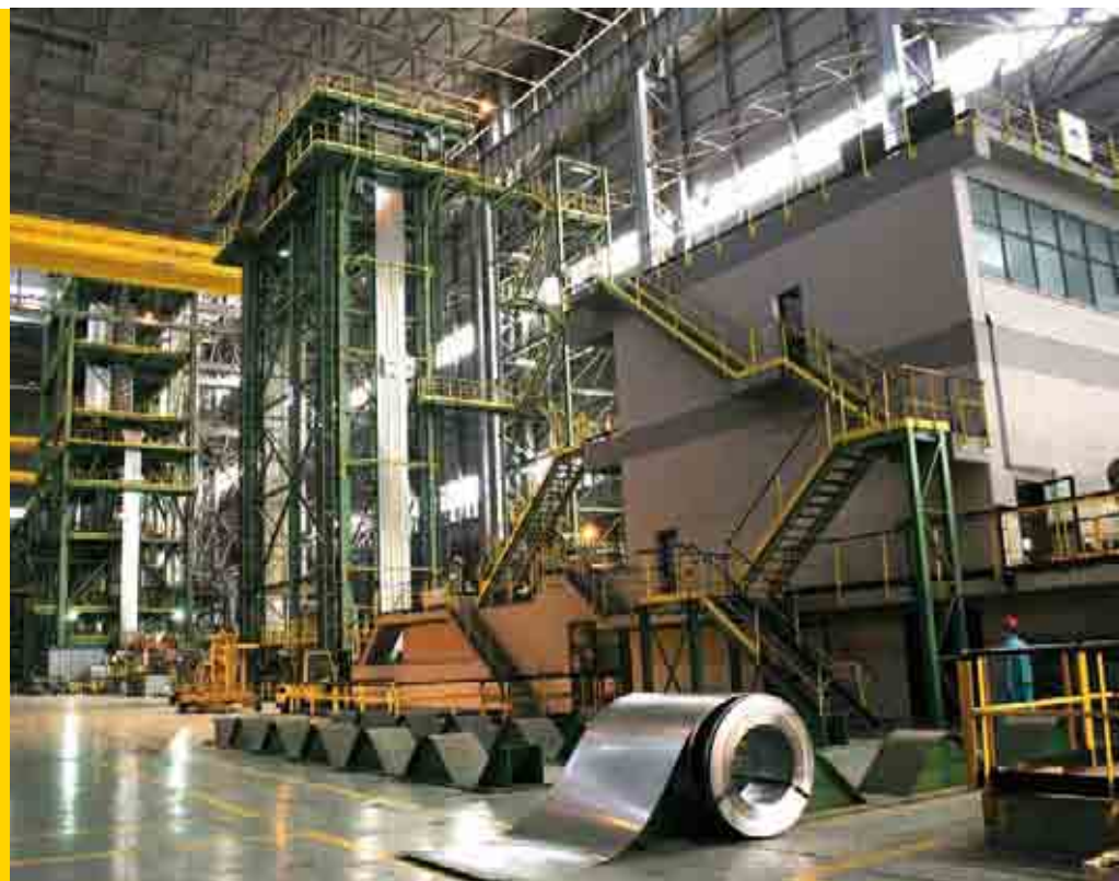
Figura 10 Impianto di zincatura a caldo
